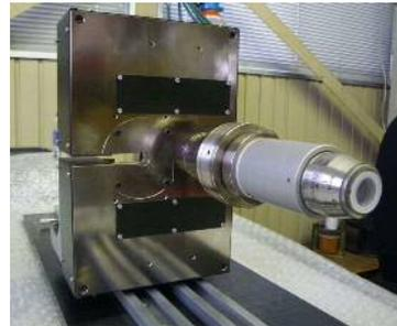
右突出部より導光したレーザー光は機体内部で分光後、中央切欠き部で集光し、中央切欠き部に設置されたチューブ接合部を溶着する。出力制御基板は出力を精緻に制御するハードウェアとソフトウェアで構成される。
