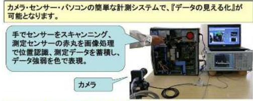
【画像と測定色マップデータの重ね合わせで測定結果評価解析】
