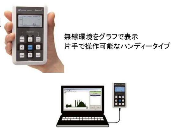
PCとUSBケーブルで接続、付属ソフトウェアで計測データをPCに取り込み CSVファイル・JPEG画像で取り出し可能
