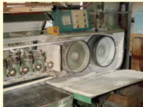
レベルサンダー：平面を削る機械 操作しやすいようにフットスイッチを設置し、押しボタンは配置を工夫している
