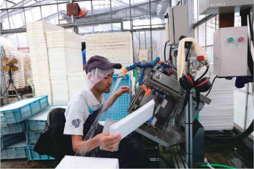
上：中にブラシを備えトレーを入れることで洗浄できるよう製作した機械 下：現在はさらに改良を加えたより効率的な洗浄機械も稼働している
