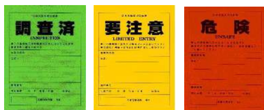
応急危険度判定により家に張り出されるステッカー （出典：応急危険度判定協議会ホームページ）
