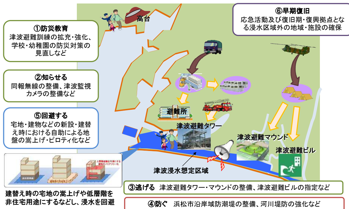
図6-4 津波対策の6つの視点に基づく推進施策のイメージ
