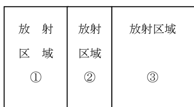
第7-5図 3放射区域のうち隣接する2放射区域の消火剤の最大貯蔵量の例
