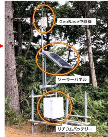
中継機 (ソーラーバッテリー) で稼働
