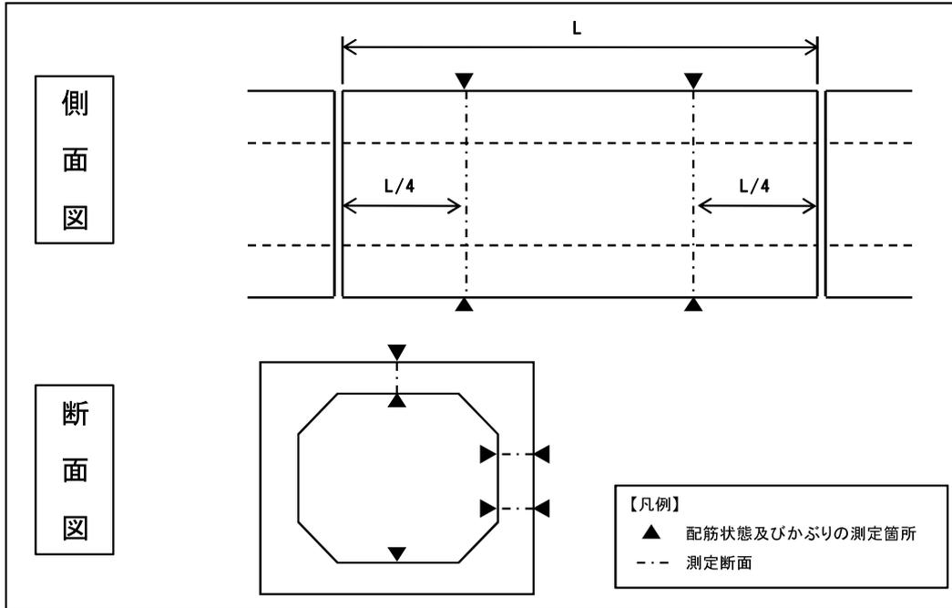
図 7 ボックスカルバートの測定位置 (例)
