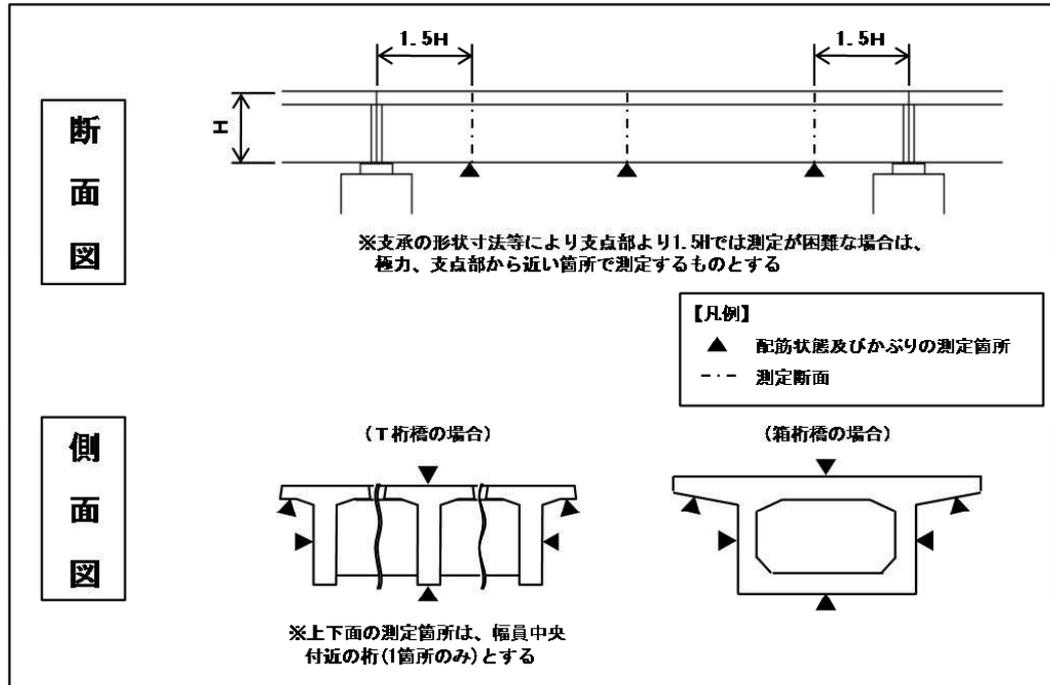
図 5 橋梁上部構造の測定位置（例）
