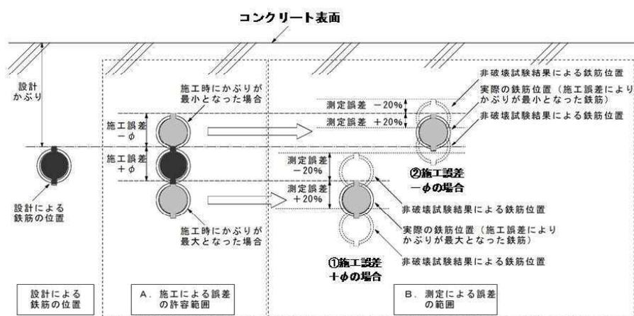
図8 かぶりの施工誤差及び測定誤差
