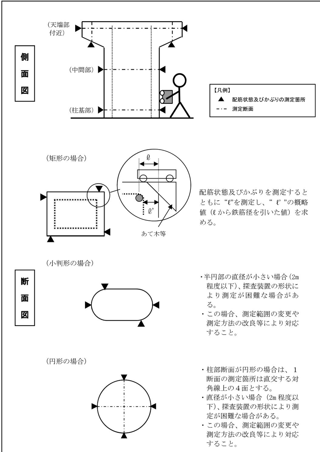
図6 橋梁下部構造の測定位置(例)
