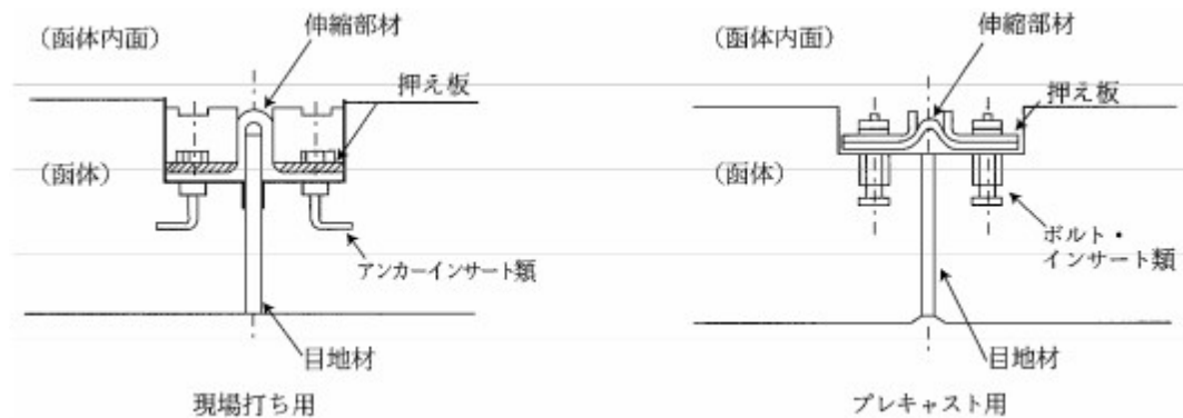
図3-1 止水板の構造(柔構造樋門設計の手引きによる)
