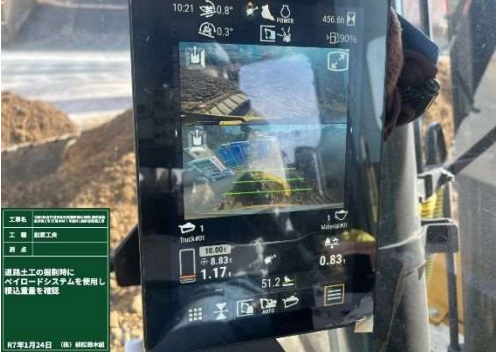
荷重軽量システム搭載バックホウの使用
