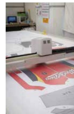
ユニフォームの柄を染め付けた大きな一枚の布を、1着ずつ最先端の裁断機が自動裁断する。
