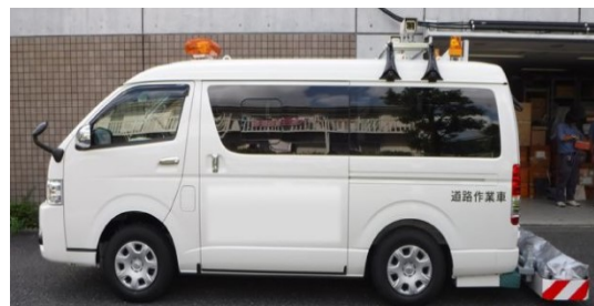
図3.6 路面空洞探査車
