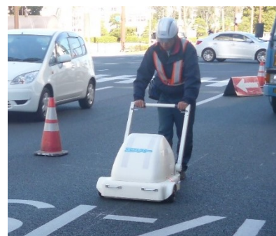
図3.7 ハンディ型レーダー探査装置
