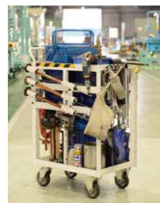
山本さんの「きさげ七つ道具」。このワゴン一つで広い工場を渡り歩く。きさげ加工を求められる場所に移動し、自分で仕事スペースを確保する。スクレーパーも、このワゴンも、自分でカスタマイズしている。
