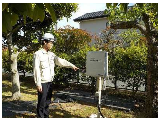
図 8 臭気モニタリングシステムの確認及び汚泥貯留槽へ消臭剤添加の確認
