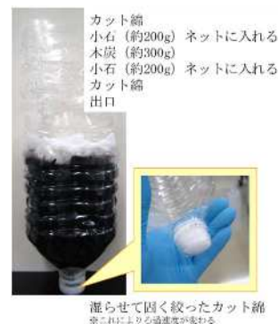
図1 作製した簡易ろ過装置
