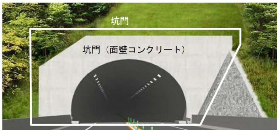
図 5.2 点検対象箇所（トンネル坑口部）
