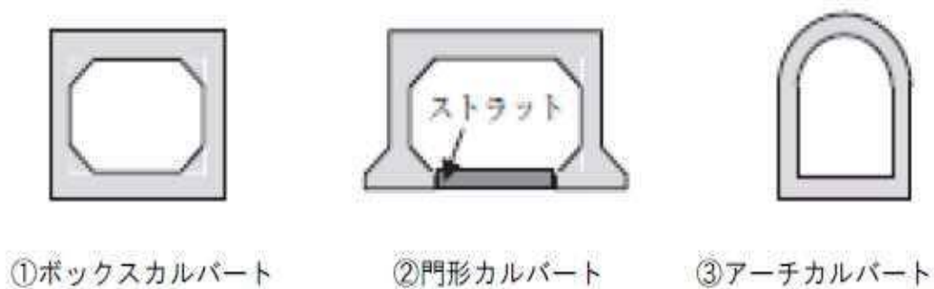
付図-3. 2. 1 対象とする大型カルバートの種類
