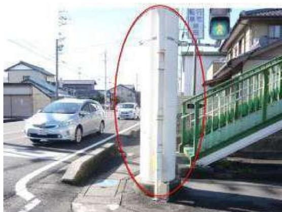
写真2 階段・橋脚により接続道路の視認性阻害状況
