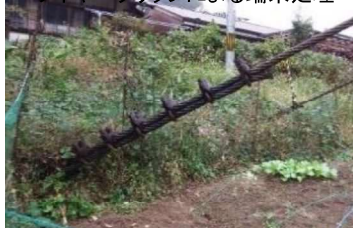
ワイヤークリップによる端末処理
