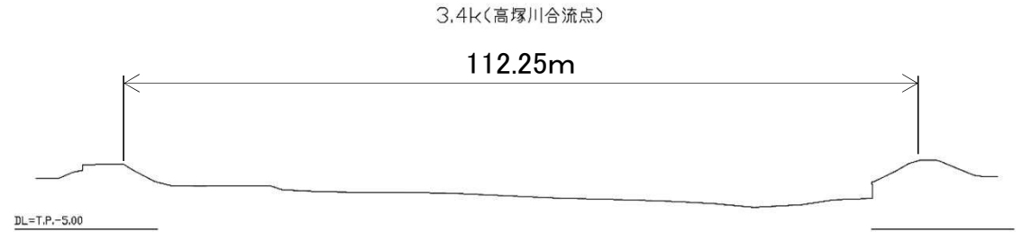
馬込川(新橋1号排水路合流部)横断図
