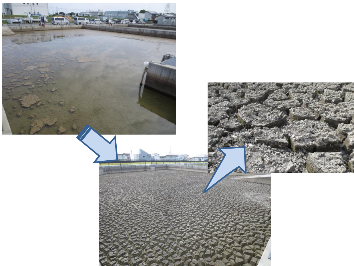
図 4.6.1 天日により乾燥される浄水発生土（天日乾燥汚泥）
