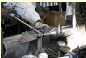
金型に添ってヘラ棒を当てて変形させていく
