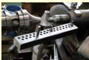
ノックピンの穴 ヘラ棒を当てる角度を様々に変えられるように数多く開けられている
