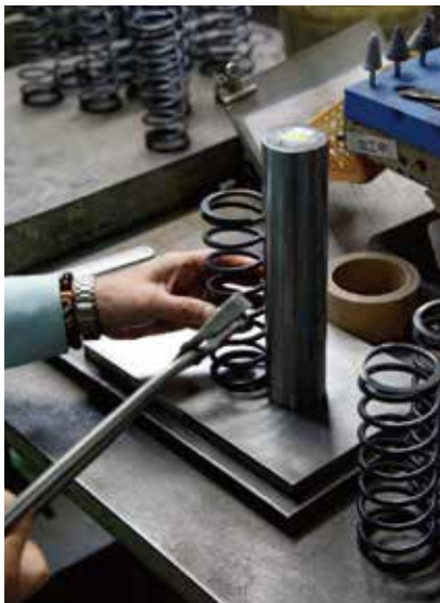
やっところを使い、ばねの寸法を要求仕様に修正する
