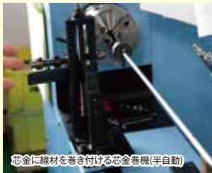
芯金に線材を巻き付ける芯金巻機(半自動)
