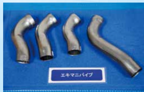
新技術開発のきっかけとなった エキゾーストマニホールドのパイプ曲げ
