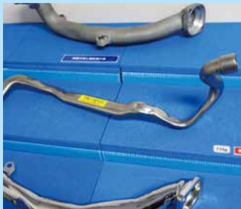
究極のパイプ加工と称した燃焼式ヒーター排気パイプ(中央)
