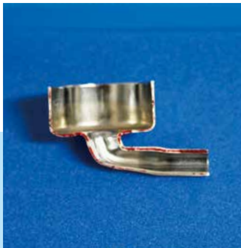
金型を使って拡管、縮管、曲げ、増肉をプレスで成形
