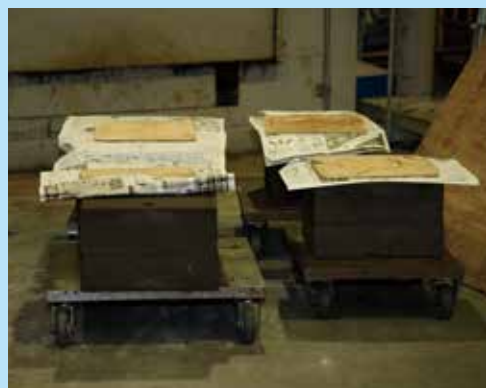
人工砂型100%使用した鑄型
