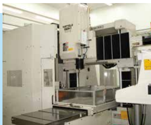
ジグボーラー:非常に高精度の加工ができるNC加工機
