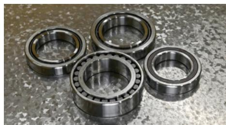
オーバーホールではまずどのベアリングを使うかを優先的に決め、ベアリングに合わせて他の部品を調整していく。スピンドルが果たす仕事の精密さ、効率の良さは全てベアリング次第といえるほど肝になる。
