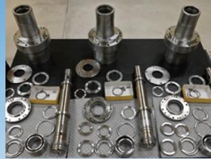
写真はスピンドルを分解した部品。組み立て作業の前日から、室温22度に保たれているスピンドル室(クリーンルーム)に並べられる。
