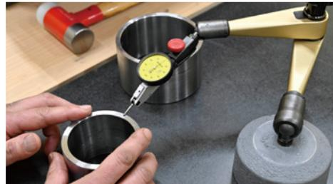
用途に応じてさまざまな測定工具を使う。写真はインジゲータ。
