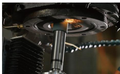
自社開発した機器によるマシニングセンタテーパー研磨の様子
