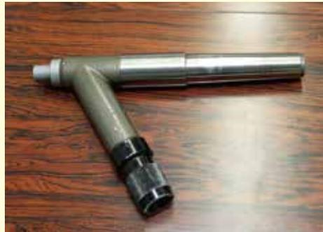
治具中ぐり盤に取り付けて加工の位置を確認するための芯出し顕微鏡
