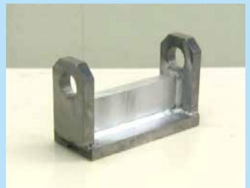
ヘッドパイプボーリング機用検査治具
