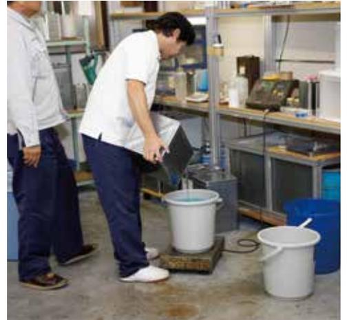
ポリオールとイソシアネートを混ぜ合わせて反応させてポリウレタン樹脂を作る
