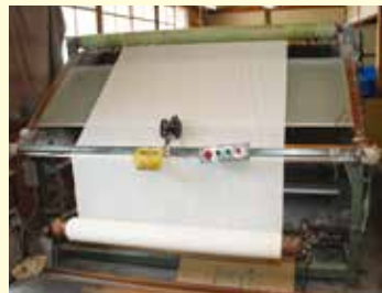
検反機：織り上がった生地 の織欠点を検査する 検査台
