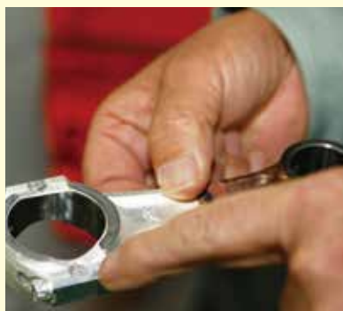
船外機のエンジン部品に銀めっきを施す
