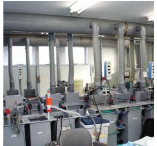
試作めっきブース／めっきの試作や数の少ないめっきは試作ブースでめっきされる
