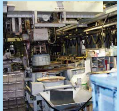
工場内のめっきライン／量産体制になると全自動ラインで生産する
