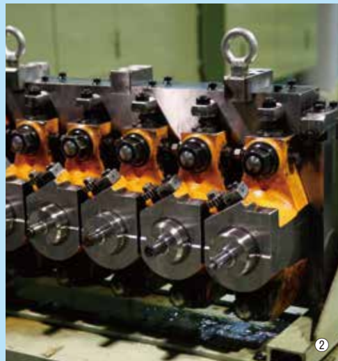
①穴に金型をセットする ②パンチで変形させる
