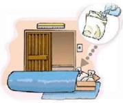
水のう in ダンボール箱 + シート
