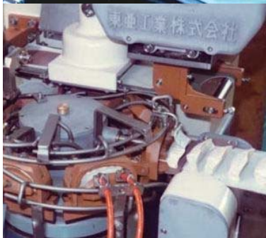
開発初期の餃子製造機。具が飛び散ったり、皮と具の間に空気が入り込むなど、課題が山積みだった
