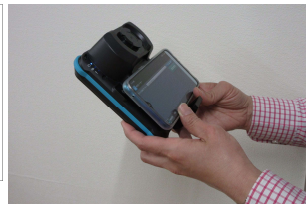
実証実験に用いたICタグリーダーとスマホ(識別番号を表示するアプリ付き)
