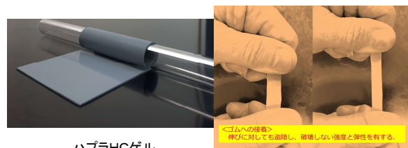
ハブラHCボンド (接着性に富み、伸びに追従する弾性を有する)
