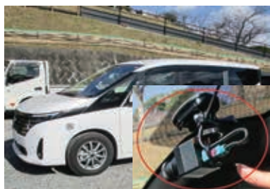
一般の公用車に搭載している道路損傷を検出するAIカメラ
