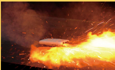
▲モバイルバッテリーからの出火(再現実験)
