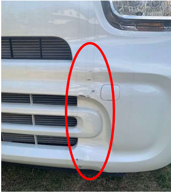
フロントバンパー左側下部二か所の塗装の剥がれ
