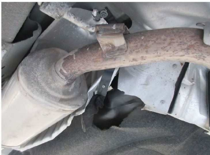
被害車両 車両底部の損傷
