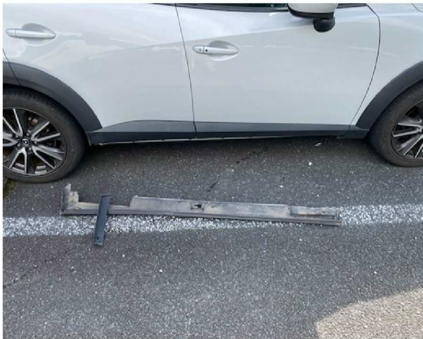
被害車両右側 （サイドアンカースカート損傷）
