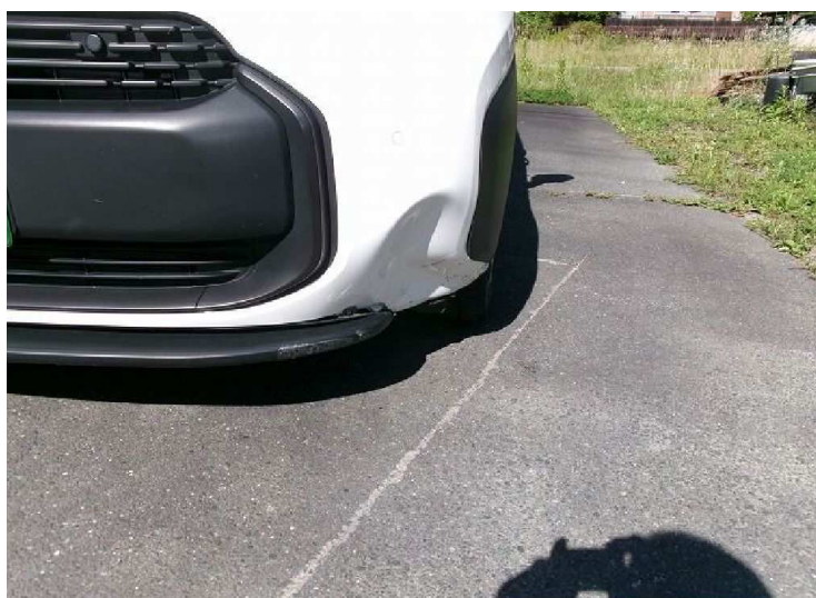
被害車両（フロントバンパー左側の損傷）
