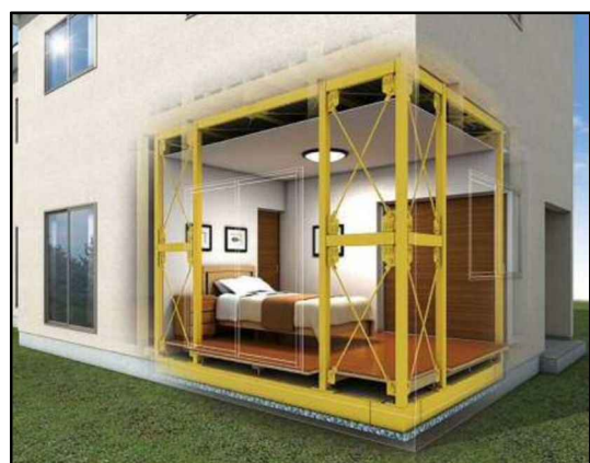
図 耐震シェルターの設置
