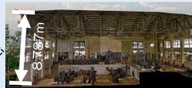
実寸法による測量が可能 （仮に損傷した場合もデータ保存により復元可能）
