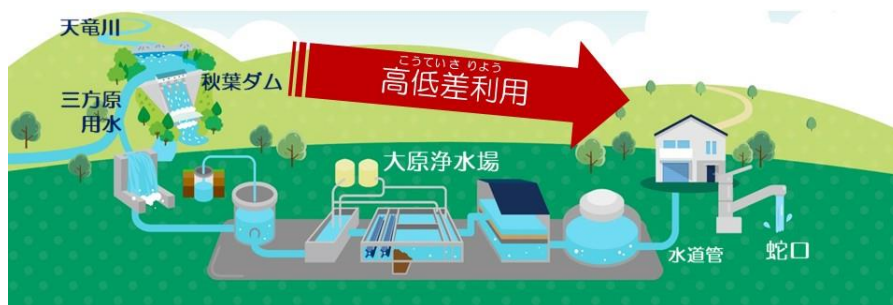
図表 2.3.14 ポンプ不要な自然流下方式 [大原浄水場]
