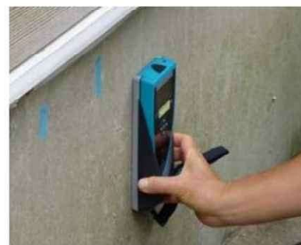
「基礎配筋」の調査機器
