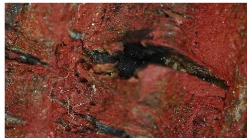
マイクロスコープによる表面観察 浜松科学館との協力により実施。黒漆の上に赤漆を塗布している状況が明確である。
