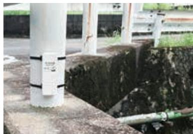
浸水常襲箇所を設置予定のワンコイン浸水センサ
