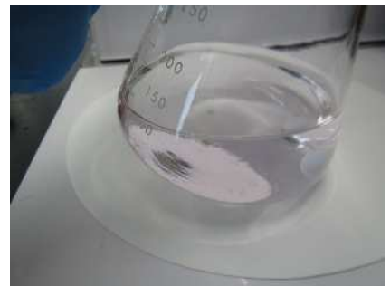
⑥過マンガン酸カリウムの滴下量から、過マンガン酸カリウム消費量を計算します
