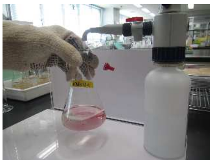
④過マンガン酸カリウムの紫色が消えていきます
