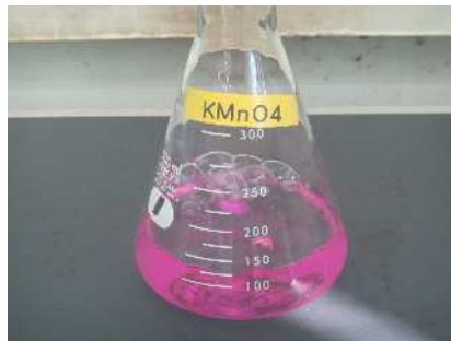
②加熱沸騰させ、さらに5分間加熱します
