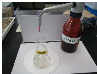
⑤透明になった溶液に過マンガン酸カリウムを滴下し、薄いピンク色がついたら検査終了です
