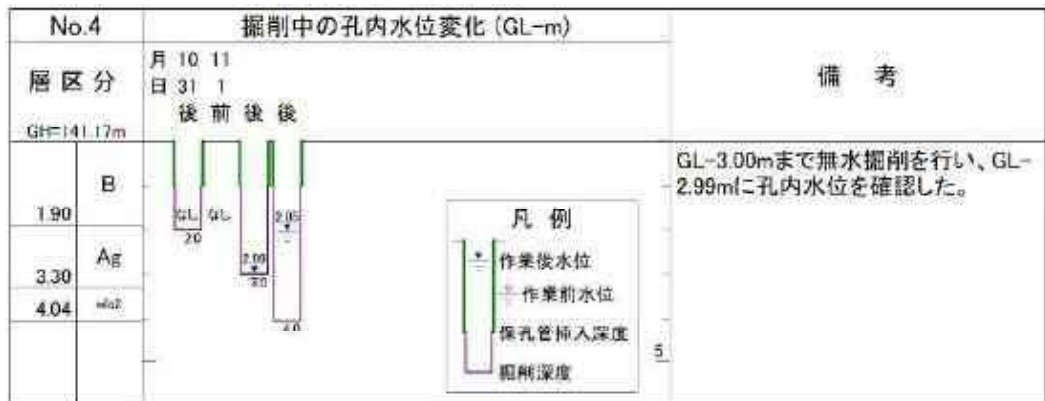
図-4.3.6 No.4地点の掘削中の孔内水位変動図
