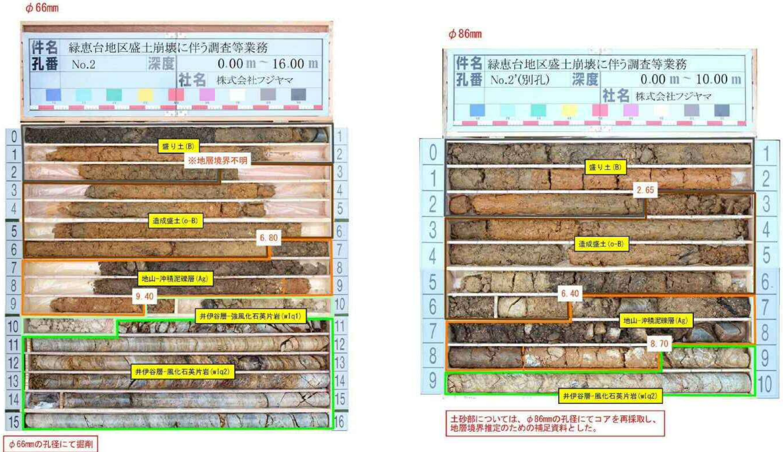
図-4.3.3 No.2の比較コア写真(本孔( \phi 66 ),別孔( \phi 86 ))
