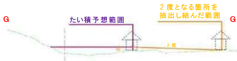
図-2.3.3 堆積範囲及び現地形の傾斜が2度となる箇所を抽出し結んだ範囲 (横断面図)
