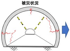
が地すべりにより へんしょう トンネル内壁に亀裂が発生
