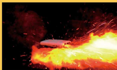
▲ Princípio de incêndio em bateria portátil (simulação)
