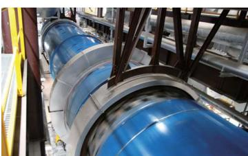
ごみを空気のない状態で、約450°Cで1時間ほどむし焼きにしてガスと炭に熱分解する。
