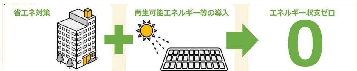
ZEBには4段階の定義があり、ZEB ReadyとZEB Orientedについては、再エネ設備を導入しなくても、エネルギー使用量の削減によりZEBランクを達成することができます。
